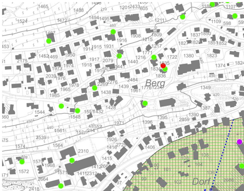
Abbildung 9: Auszug aus der Grundwasserkarte mit Isohypsen (Geoportal 22.09.2022) grüne Punkte sind Erdwärmesonden, rote Punkte sind Quelfassungen
